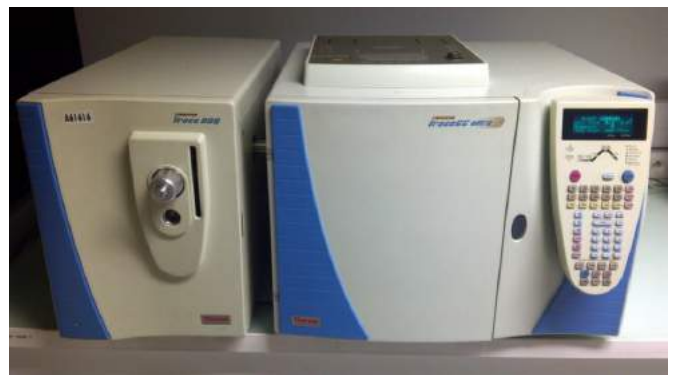
Figure 2 Appareil à GC-MS utilisé par l'auteur.
