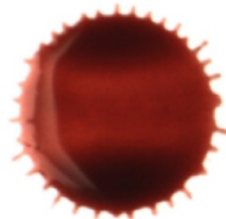
Figure 55: Formation d'épines périphériques (« spikes ») au bord de la trace.
