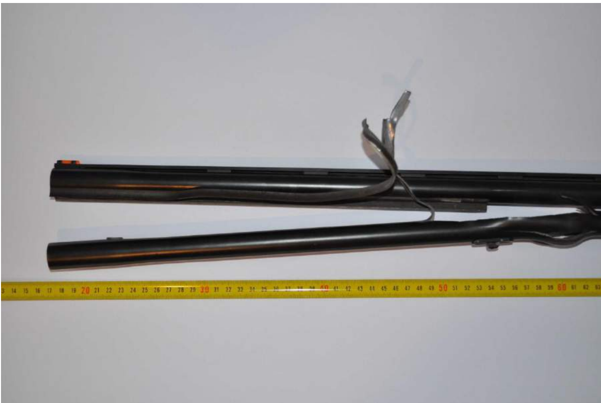
Figure 1 : Vue d'ensemble du canon de fusil de chasse éclaté.
