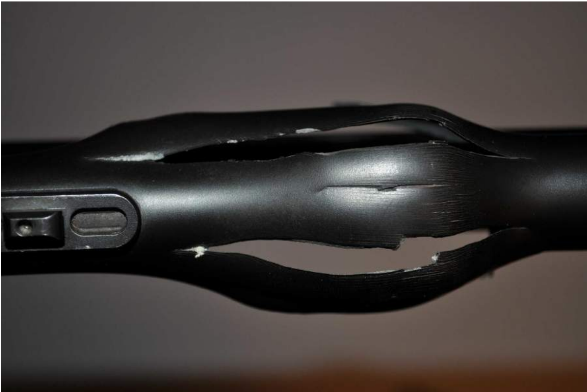
Figure 2 : Vue rapprochée de la zone déformée du canon accidenté.
